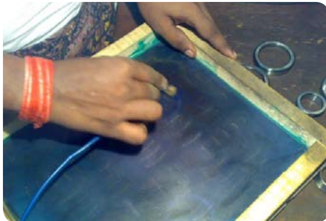
Padělané značení je vyleptáno na ložisko pomocí síťotiskové šablony
