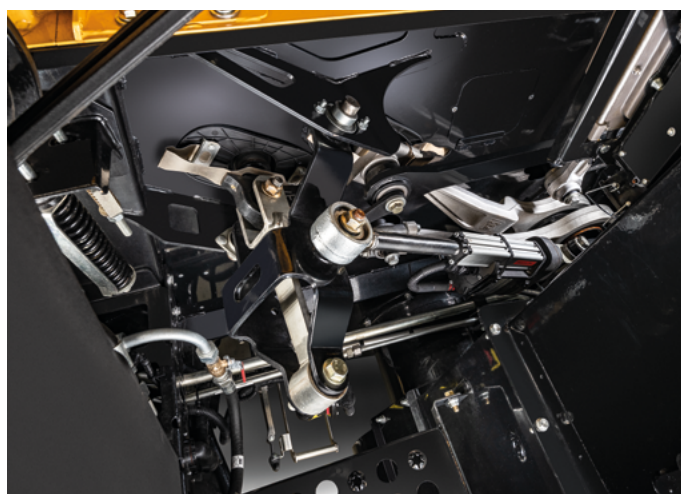
Systém příčného vyrovnávání sítové skříňe SmartSieve pro sekci horních sít
