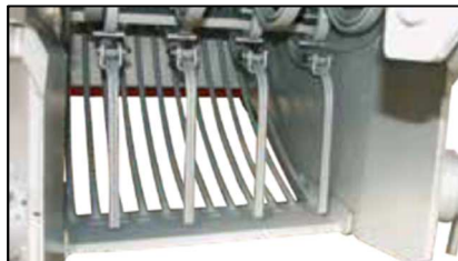
Sběrací buben modelu SB4000 má rotor s 18 prsty a SB5200 má prstů 24
