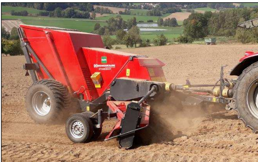
SB5200 s koly 700/45-22,5 a kryty hrabacích rotorů
