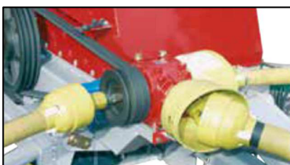
Středový rotor je poháněn převodovým řemenem
