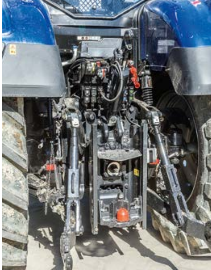
Až šest vnějších hydraulických okruhů a zvedací síla 9,5 t jsou excelentní parametry. My nevíme, proč se spojovací prvky na hydraulických pístnicích otáčejí, ale víme, že to vede k únikům oleje.
