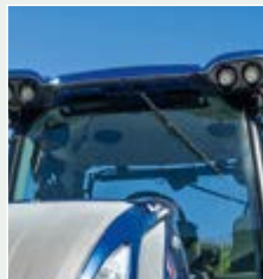
Přední stěrač stírá pouze v úzkém úhlu a horko z výfuku jde přímo na sklo.
