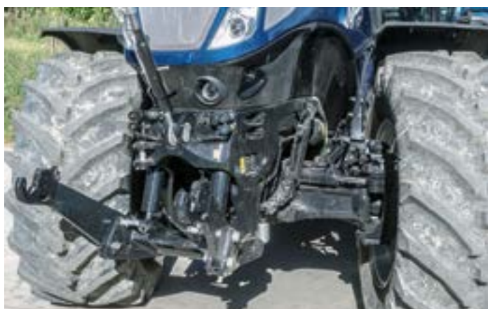
Nový systém odpružení má hydraulické pístnice umístěné z vnější strany a umožňuje troje nastavení. Přední tříbodový závěs zvedne víc než 4,5 t.
