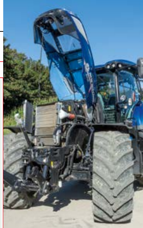
Obrovská kapota pro obrovský výkon - motor s objemem 6.7l od výrobce FPT je hospodárný a velmi silný fotografie ST, HW.
